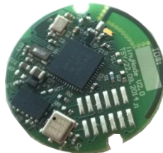
Figure 20. Coin sized VTT TinyNode BLE sensor-tag.
